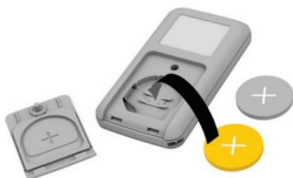
3. Insérez la nouvelle pile. Vérifiez que le signe « + » se trouve sur le dessus. Veillez à ne pas endommager les contacts des piles.
