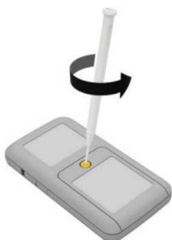
1. Déverrouillez le cache-piles en dévissant dans le sens inverse des aiguilles d'une montre à l'aide d'un petit tournevis cruciforme.
