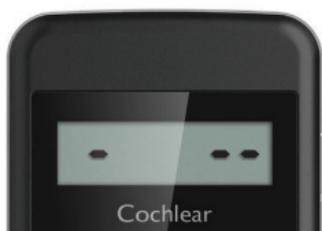
Lorsque la télécommande n'est appairée avec aucun processeur, des tirets (voir ci-contre) apparaissent à l'écran et clignotent lorsque vous appuyez sur les touches.
