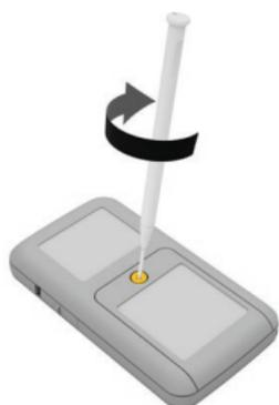
5. Verrouillez le cache-piles en vissant entièrement la vis dans le sens des aiguilles d'une montre à l'aide d'un petit tournevis cruciforme.
