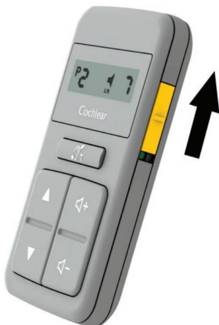
Lorsque l'interrupteur est positionné vers le haut, la télécommande se met en veille si elle n'est pas utilisée. Pour la remettre en marche, appuyez sur n'importe quelle touche.
