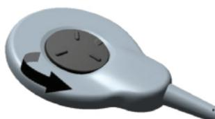
1. En tenant l'antenne avec les poignées vers le haut, dévissez l'aimant dans le sens inverse des aiguilles d'une montre.
