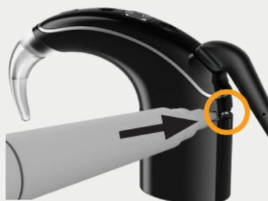
2. Poussez le bouton de verrouillage/déverrouillage complètement vers la droite pour déverrouiller le module de batterie/piles.
