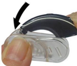
3. Appuyez sur le haut de l'unité de traitement lorsque vous fixez le module de batterie afin de vous assurer que la languette métallique sur la pince Koala s'insère dans le boîtier de l'unité de traitement.
