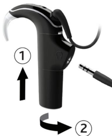
3. Insérez le module de batterie/piles, puis tournez-le pour le connecter.
