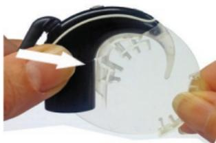
2. Fixez l'antenne à l'adaptateur de port pour processeur.
