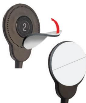
2. Fixez le coussinet sur le côté tête de l'antenne en appuyant fermement.
