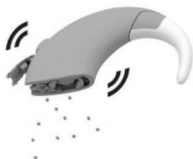
Si des grains de sable ou de la poussière pénètrent dans l'unité de traitement, secouez les composants avec précaution pour faire ressortir les corps étrangers.
